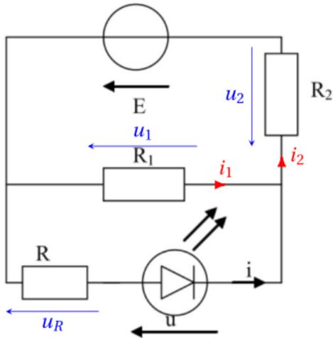
On cherche la résistance  $R_1$  minimale permettant à la DEL de fonctionner dans le sens passant. La tension aux bornes de la DEL vaut donc  $V_s = u_R + u = u_1$  et elle est traversée par un courant  $i = 0$ . La loi des nœuds donne ainsi  $i_1 = i_2$ . On applique un pont diviseur de tension sur la résistance  $R_1$  (attention ! On peut utiliser le pont uniquement quand  $i = 0$ , ce qui est le cas ici).
