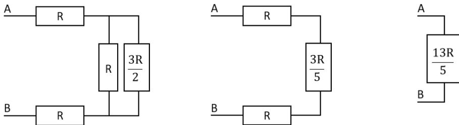
3) On peut réécrire le circuit de la manière suivante. On en déduit la résistance équivalente :
